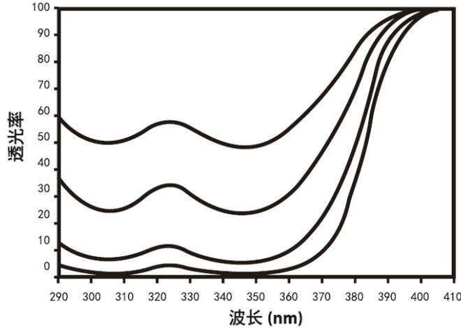
UNIQ<sup>®</sup> LIGHT 984 是专为汽车涂料开发的苯并三唑类紫外光吸收剂，其吸收波长范围为 290nm 到 370nm 左右。由于其较高的分子量，该产品比 UNIQ<sup>®</sup> LIGHT 930 具有更好的耐热性和更佳长期稳定性，更适用于汽车涂料的高耐候要求。如果用于清漆体系，建议与 UNIQ<sup>®</sup> LIGHT 992/UNIQ<sup>®</sup> LIGHT 923 一起使用，效果更佳。应用与水性体系须先与助溶剂稀释后，搅拌条件下加入到体系中。
